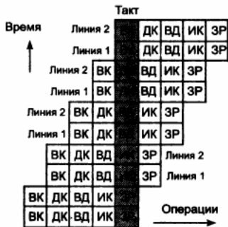
Рис. 8: Суперскалярный конвейер из двух линий
