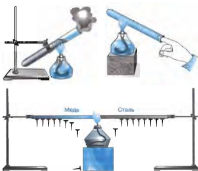
Рис. 6 : Теплопроводности различных тел
