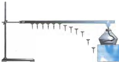
Рис. 5 : Опыт по теплопроводности
